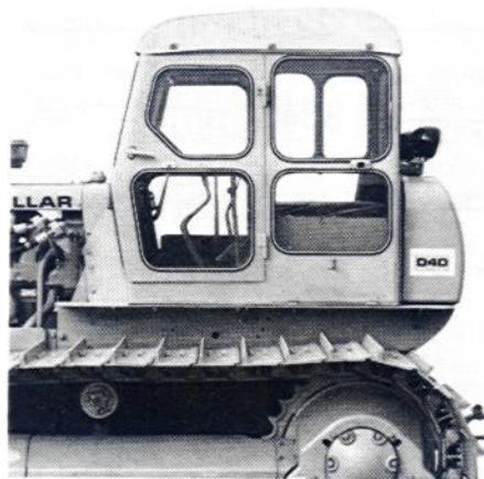
Kettendozer D4D-Moor mit Zeppelin-Fahrerhaus
